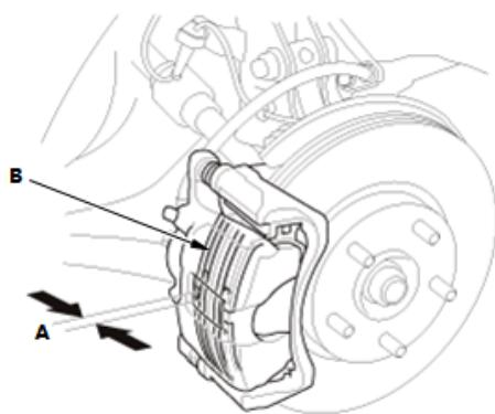
1. 检查内制动片 (B) 和外制动片 (C) 的厚度 (A)。不包括底板厚度。
